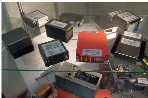
**C'est au cœur de Neuchâtel que se niche depuis 21 ans la société Spectratime, spécialisée dans la fabrication d'horloges atomiques miniatures. Peu savent réaliser ces objets de haute technicité et d'une redoutable précision, faisant de Spectratime un leader sur le marché européen et mondial.**
